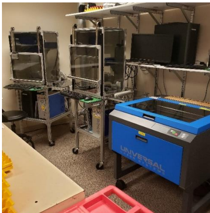
Lasers, 50 & 30 Watt Fiber & 50 Watt CO2
